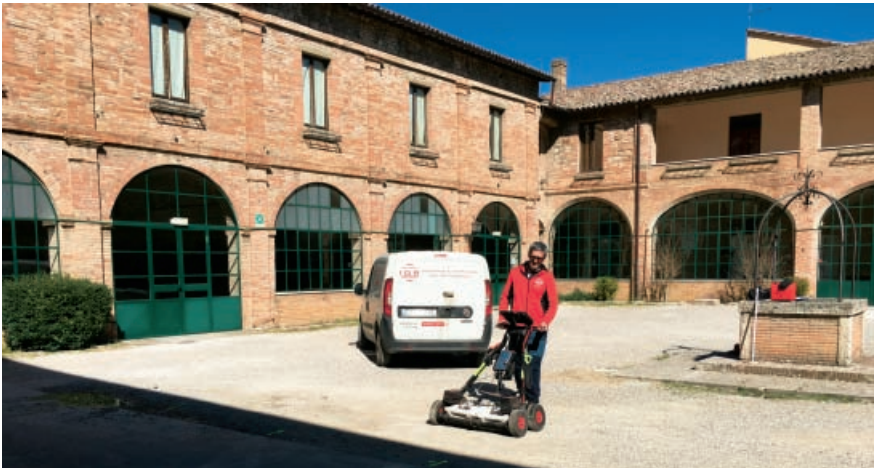
Fig. 2: Fase di acquisizione dati con la strumentazione georadar nel sito in oggetto
